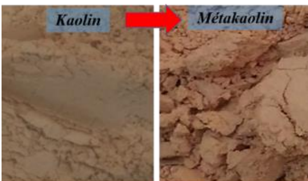
Transformation du kaolin en métakaolin
